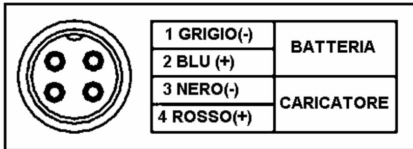
Detto caricatore è **raccomandabile nel caso delle bilance doppie corpo 2 batterie di alta capacità**. In detto caso, con il caricatore interno della bilancia, il tempo di ricarica è superiore a 32 ore. Utilizzando un caricatore esterno detto tempo può essere ridotto a 12 ore.
