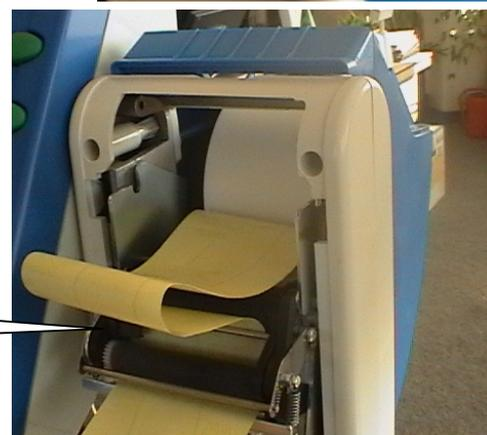
Avvolgete parte del supporto siliconato sul riavvolgitore e fissatelo con l'apposita molletta.
